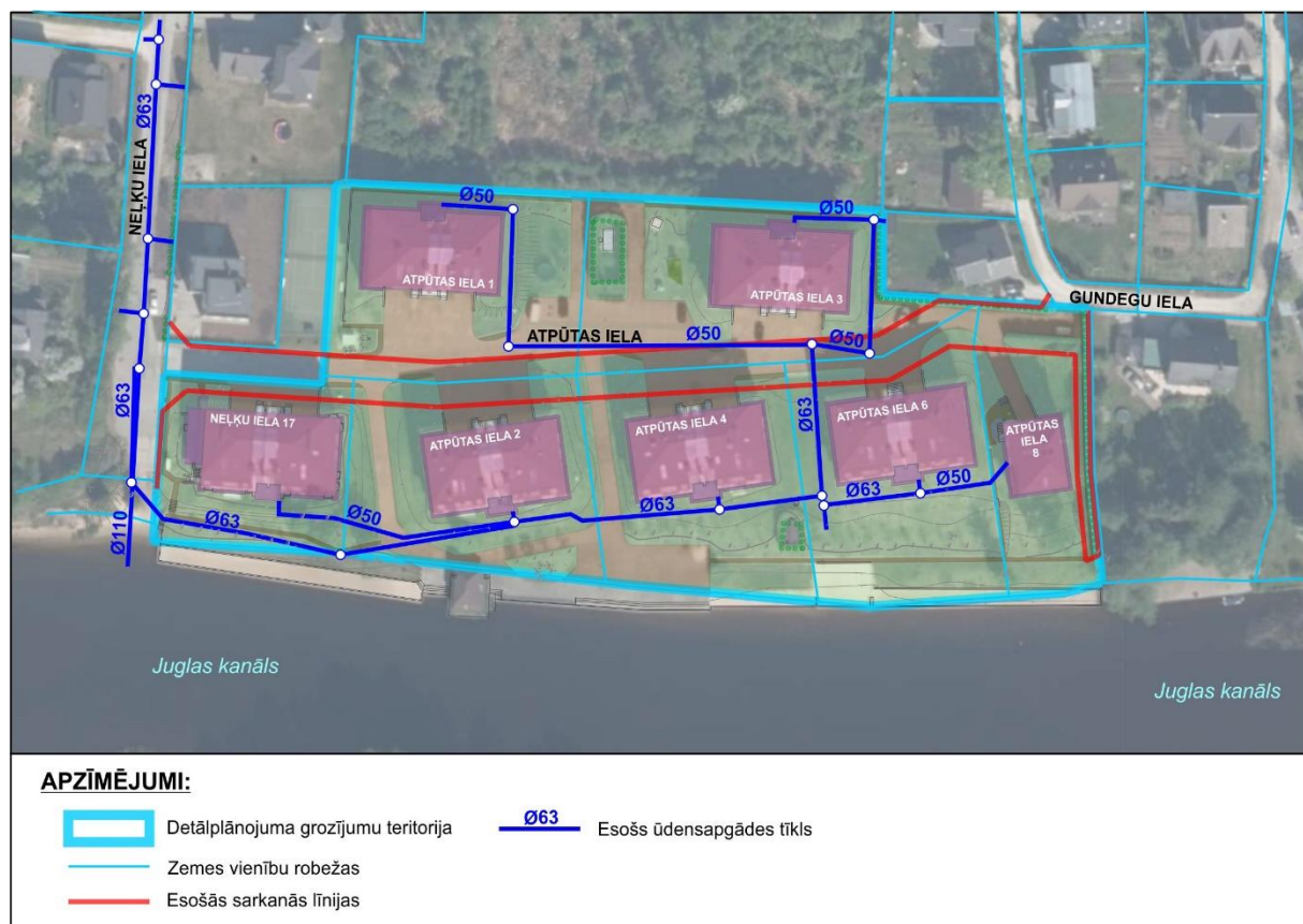
2.4.attēls. Ūdensapgādes shēma
