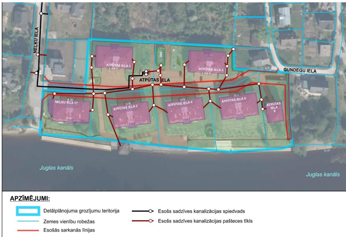
2.5.attēls. Sadzīves notekūdeņu kanalizācijas shēma
